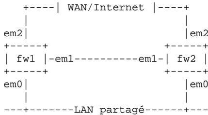
Les interfaces em1 des pare-feu sont connectées à l'aide d'un câble croisé. Les interfaces em0 sont connectées au LAN et les interfaces em2 sont connectées à un réseau WAN ou à Internet. Les adresses IP utilisées sont les suivantes :
