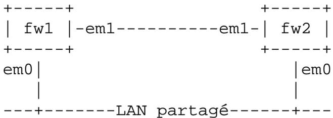
Les interfaces em1 des pare-feu sont connectées à l'aide d'un câble croisé. Les interfaces em0 sont connectées au LAN et les interfaces em2 sont connectées à un réseau WAN ou à Internet. Les adresses IP utilisées sont les suivantes :
